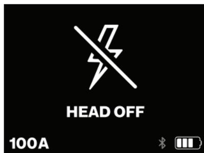
L'appareil peut passer en mode « Head Off » uniquement lorsque vous sélectionnez « Head Off » à partir de la télécommande ou de l'application. Lorsque l'appareil est réglé sur le mode Head Off, la fonction flash et l'éclairage continu sont désactivés.
